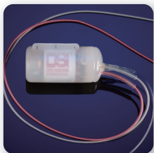
体温1ch + 圧1ch + 生体電位1ch (C50-PXT)
